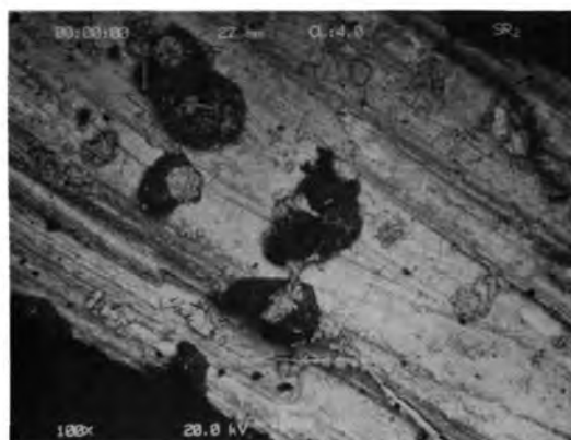
17. ábra termésken (fekete), Sb-oxid , Sb-Fe-oxid (szürkésfehér) antimonit-kristály felületén. Gyöngyössolymos. SEM-felvétel
